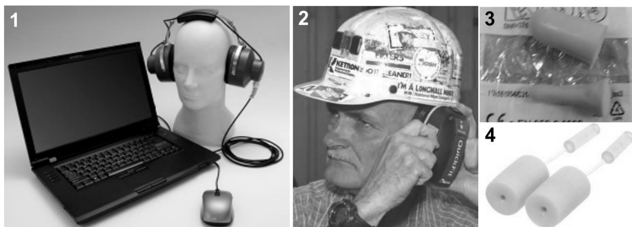
Рис. 1. 1 – первый прибор для измерения у рабочих на заводах FitCheck Solo; 2 – шахтёр регулирует громкость у прибора QuickFit; 3 – медленное расширение вкладышей позволяет глубоко вставить их в слуховой канал; 4 – беруши с зондом для замеров ослабления шума
