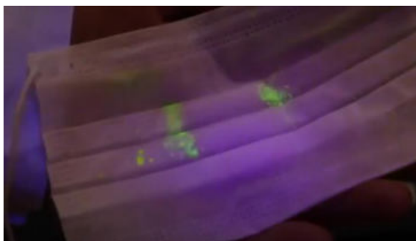
а) следы аэрозоля на внутренней поверхности маски
